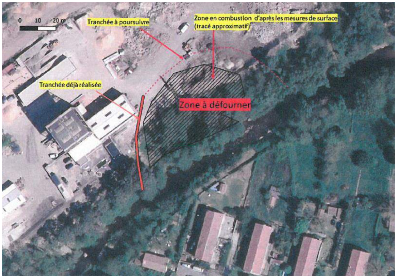
Figure 4 : Emprise de la zone de combustion et tracé approximatif de la tranchée envisagée par GEODERIS en Janvier 2020
