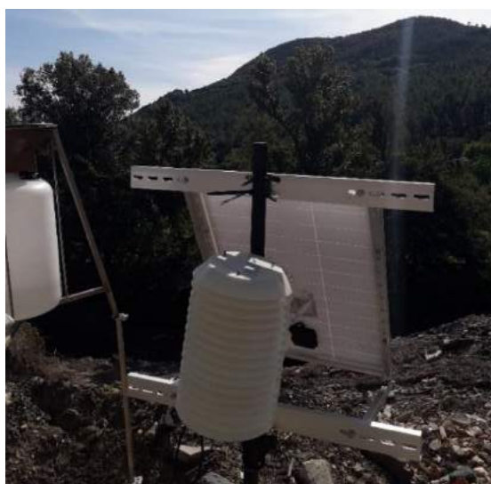
Figure 34 : NEMo Extérieur, surveillance de la Qualité de l'Air Extérieur
